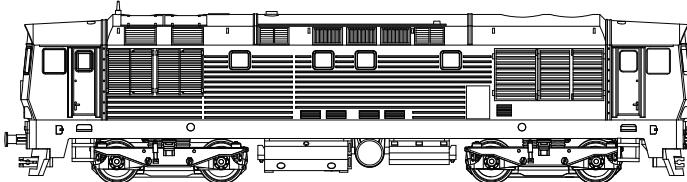
Diesel-elektrická lokomotiva řady 759 (ex. T499.0) byla vyrobena v ČKD Praha v roce 1974 v počtu 2 prototypů, s určením pro vozbu rychlíkových vlaků.
